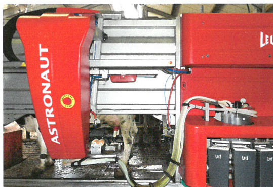
Afb. 1.18 De uier wordt gereinigd en de melkbekers worden aan de spenen aangesloten.
