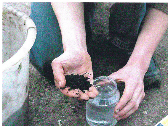
Afb. 1.3 Vul het potje met eenderde grond en tweederde schoon leidingwater om de pH te kunnen meten.
