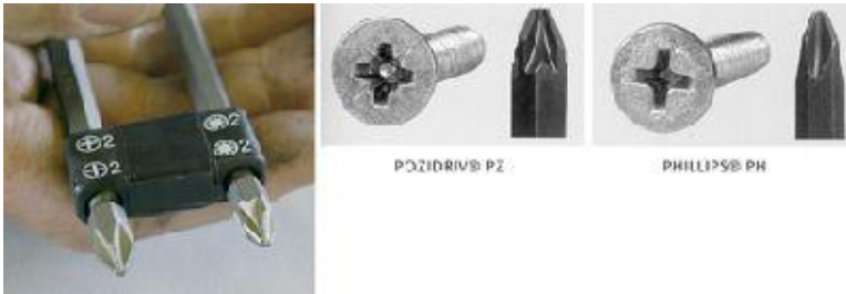
Figuur 11-8: Verschillen pozidriv en Phillips Bron: Facom
