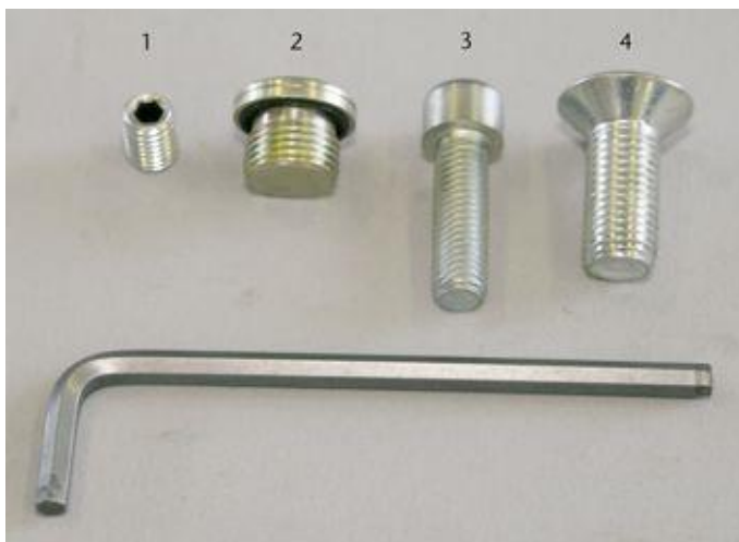
Figuur 11-3: Verschillende inbusbouten en inbussleutel
