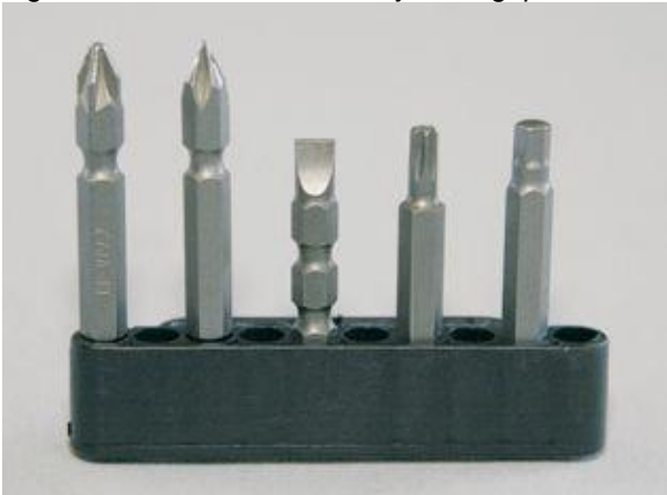
Figuur 11-14: Verschillende bitjes die geplaatst kunnen worden in een accuboormachine
