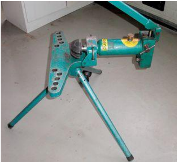
Figuur 6-2: Een pijpenbuigmachine wordt gebruikt voor dikke of zware pijpen.
