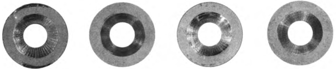
Figuur 6.51 Beschadigingen door afgeronde tanden in verschillende materialen (na het losdraaien van de bout)
