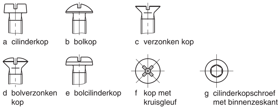
Figuur 6.34 Kopvormen van schroeven
