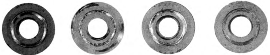
Figuur 6.52 Toepassing van flensbouten met vertanding
