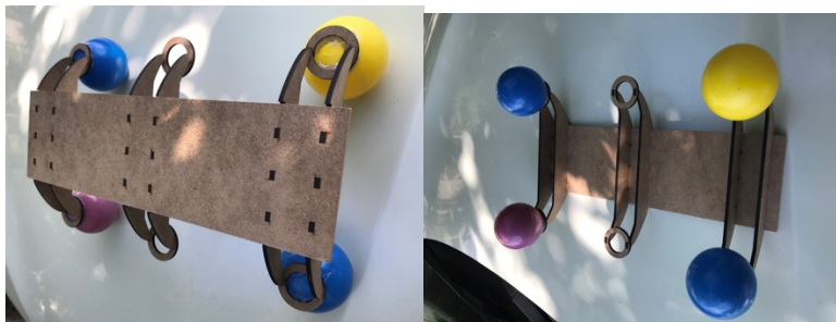
Figure 2: Eerste prototype van een pneumatische pontonbrug (Foto © Gultekin Cakmakci & Durdu Tongut)
