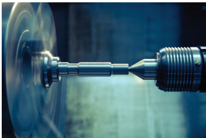
Figuur 2.23 Product in drieklauw en ondersteund door meedraaiend center
