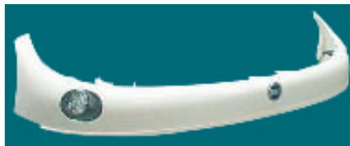
Koplampbehuizing van de Fiat Multipla, verlijmd met Araldite lijm.
