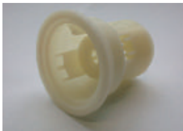
Remonderdeel. Prototype uit RenShape SL 7560 fotopolymeer.
