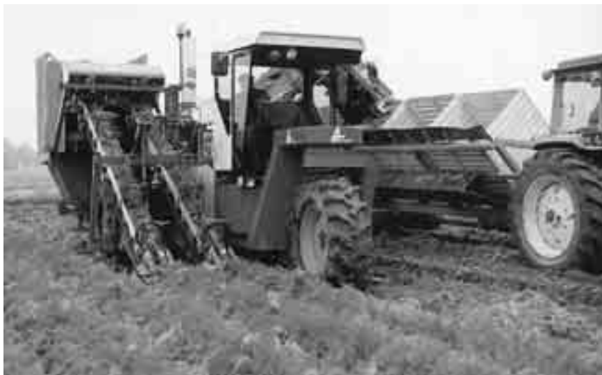
Fig. 3.6 Klembandrooier voor het rooien van wortelen. Gekantelde kisten voorkomen grote valhoogtes en rooibeschatiging.
