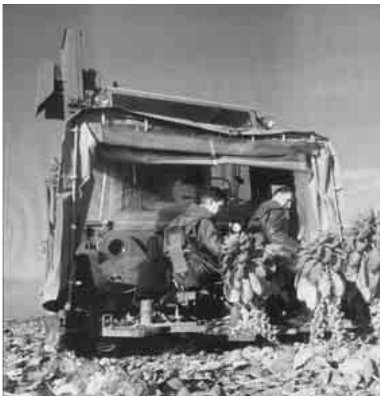
Fig. 3.7 Een drierijige spruitenplukmachine
