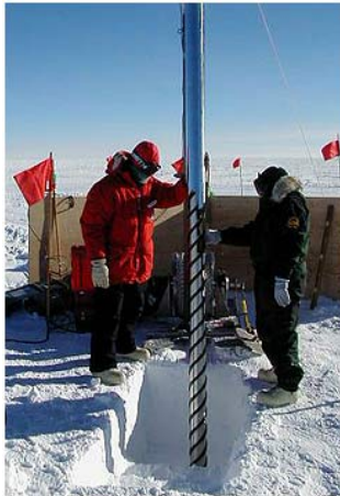
Figuur 17. Wetenschappers boren ijskernen uit de poolkappen. Deze ijskernen bevatten informatie over het klimaat van vele duizenden jaar oud.
