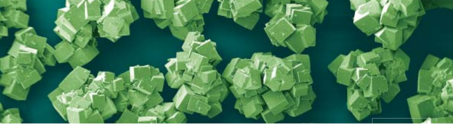
Metalen «nanoblokjes» van BASF kunnen met hun nanoporositeit grote hoeveelheden water opslaan.
