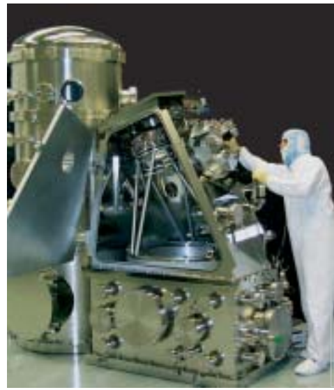
Prototype van een EUV-waferstepper-installatie voor de productie van toekomstige chipgeneraties
