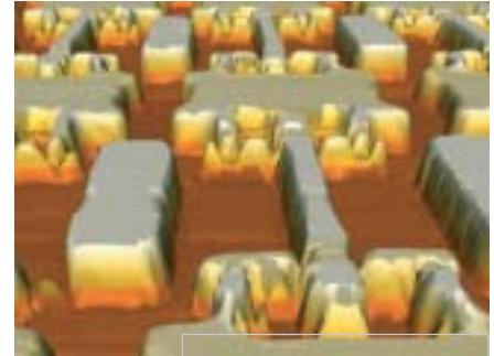
Met «capacitieve» probes kunnen de schakelprocessen op een chip zichtbaar worden gemaakt.
