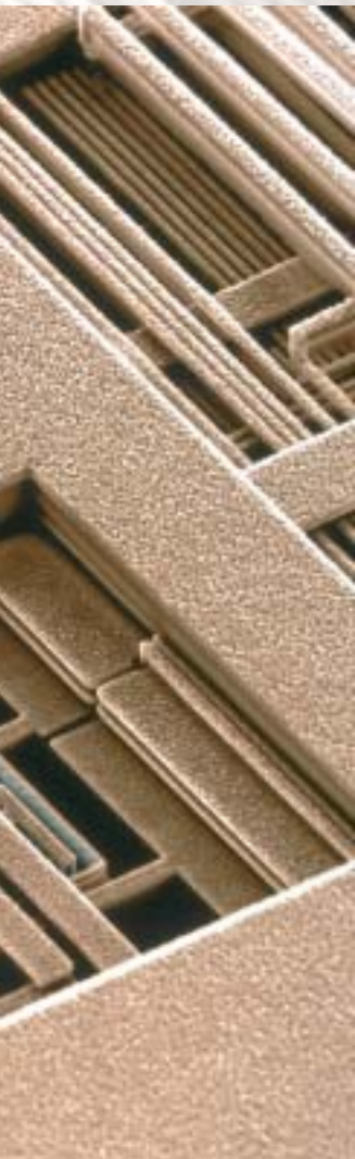
Zo ingewikkeld als een stad – door etsing blootgelegde koperverbindingen op een chip (IBM), afgebeeld met behulp van een rasterelektronenmicroscopie. Moderne chips hebben tot negen bedradingslagen.
