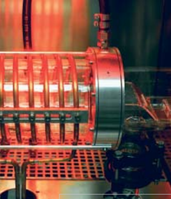
Aixtron-reactoren voor onderzoekdoeleinden (links) en voor de tot op het atoom nauwkeurige vervaardiging van dunne films van verbindingshalfgeleiders (rechts)
