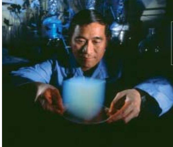
Aërogeel als wetenschappelijke stofzuiger. Ingevangen deeltjes worden veilig ingesloten in een gesmolten aërogeelmassa.
