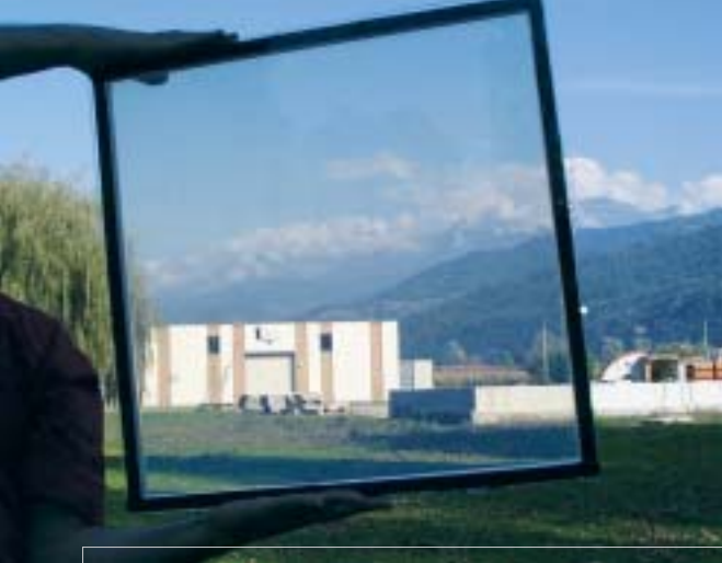
Met aërogeel gevuld dubbel glas stopt warmteverliezen.
