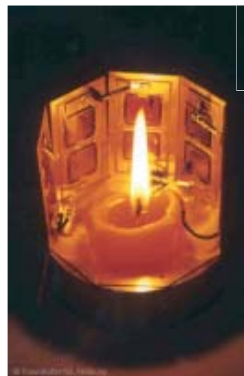
Bij thermofotovoltaïsche cellen is kaarslicht al voldoende om een radio te laten spelen.
