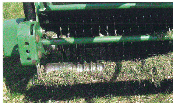
Afb. 3.9 Verticuteren kun je het beste doen met een verticuteermachine. Je haalt hiermee de dode grassen en de mossen uit het gazon, zodat het gazongras beter kan groeien.
