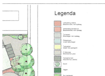
Afb. 3.3 In de legenda is elk gebruikt symbool in de ontwerp-tekening met een vakje weergegeven. Ernaast staat de betekenis. © Wille landschaps- & begraaf-plaatsarchitectuur
