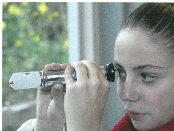
Afb. 2.2 Met een refractometer bepaal je het suikergehalte.
