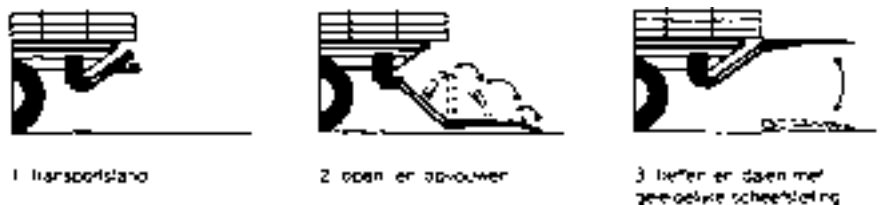
Fig. 2.7 Met een opvouwbare laadklep kun je ook goed gebruikmaken van een laadperron.
