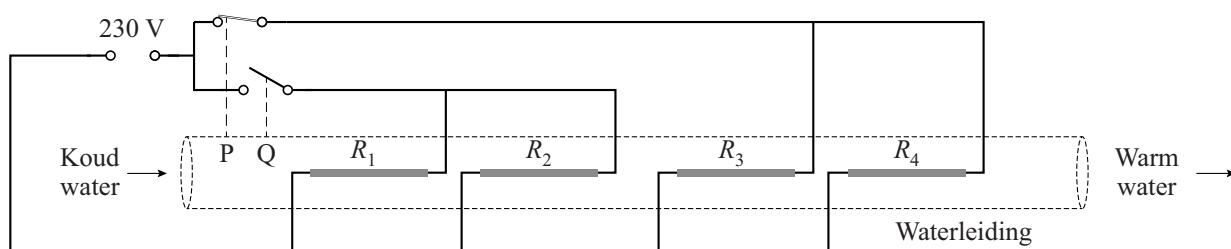
Bij weinig watergebruik is alleen schakelaar P gesloten. Als de vraag naar water groter is, zijn beide schakelaars P en Q gesloten.
