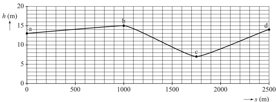
In deze figuur zijn drie trajecten ab, bc en cd aangegeven. De motor van een road-train met een massa van 160 ton moet op traject ab meer vermogen leveren dan op een horizontale weg.
