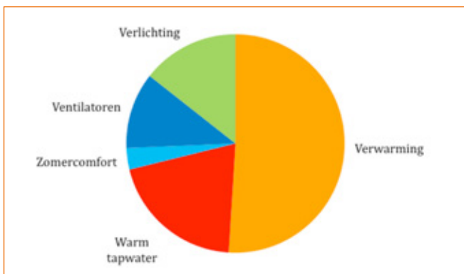
Verdeling primaire energiegebruik (NEN 7120) voor een 2-onder-1 kapwoning met balansventilatie
