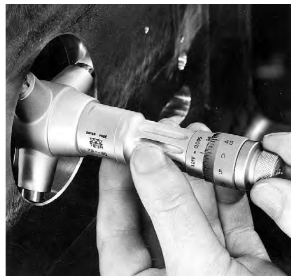
b driepunts binnenschroefmaat (imicro)
