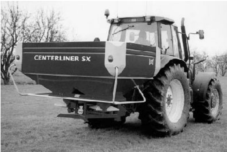
Figuur 2-1: Bij een tweeschijfs-centrifugaalstrooier komt links en rechts evenveel kunstmest terecht.
