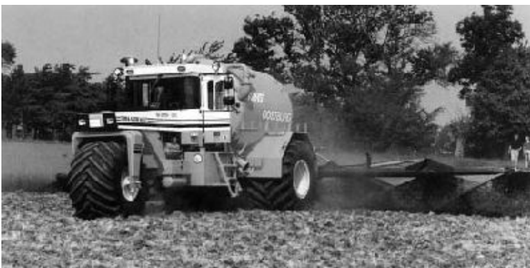
Figuur 2-6: Vloeibare schuimaarde kun je uitrijden met een drijfmesttank met een sproeiboom.
