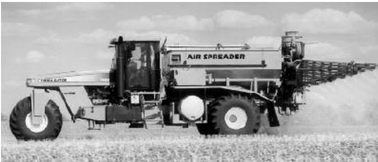
Figuur 2-3: Een zelfrijdende pneumatische kunstmeststrooier is geschikt voor zeer nauwkeurig werk.
