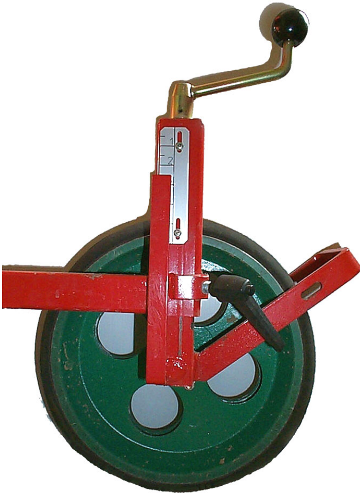
Figuur 3.10. Een verstelbare aanduiding van de zaaidiepte
