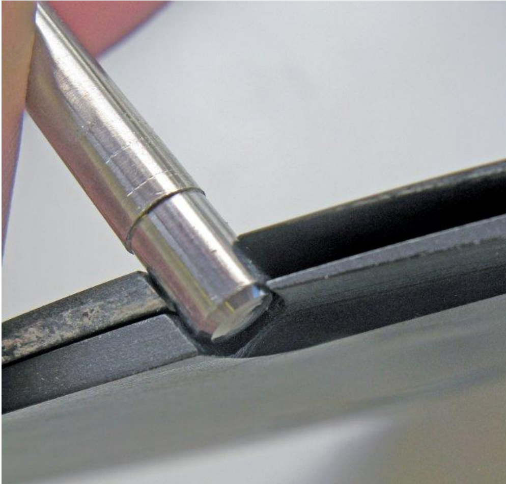
Figuur 3.13. Twee van de gebruikte zaaischijven op de demonstratie bij Beet Europe 2010. De zaaischijven van het type Monopill zijn afgekeurd als het smalle gedeelte van de meegeleverde paspen door één of meer cellen van de schijf heen kan steken (bovenste schijf). Bij een goedgekeurde schijf blijft de paspen in de cel steken (onderste schijf). Het verschil is een fractie van een millimeter
