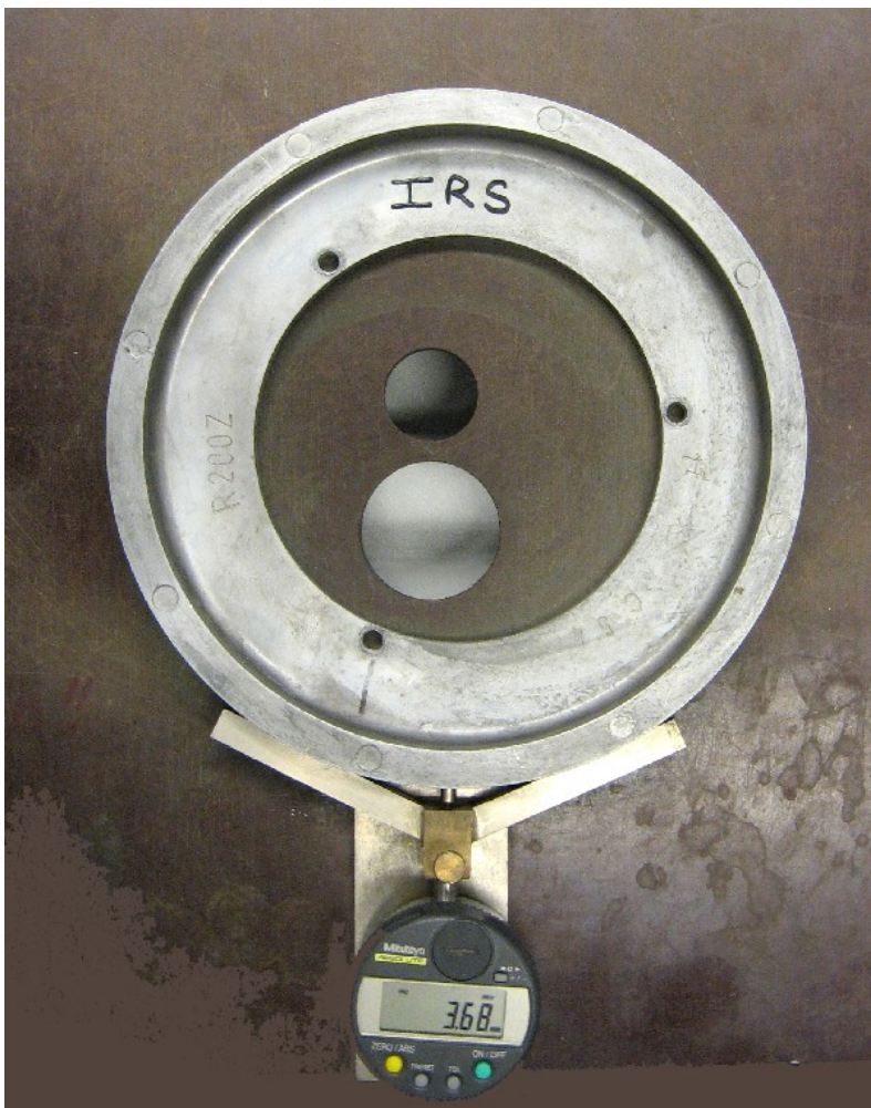
Figuur 3.12. Een micrometer meet de celdiepte van de schijf
