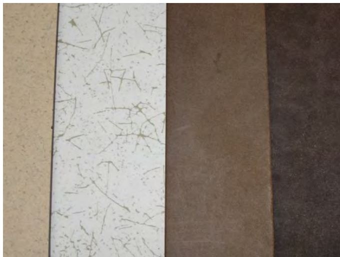
Figuur 9: Labschaal vezelplaatmateriaal op basis van kokosbolster
