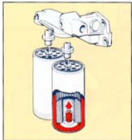
De oliefilters Trekkermotoren worden uit veiligheidsoverweging veelal uitgerust met twee parallel opgestelde oliefilters. Alle olie wordt over beide filters verdeeld en gereinigd. Als een filter sterk vervuild raakt, opent de omloopklep en gaat de olie ongefilterd verder.
