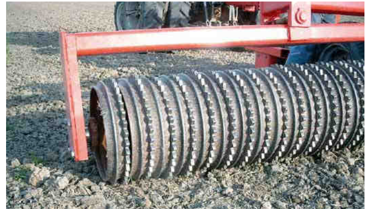
▲ Cambridgen drukt de losse zaaivoor aan, waardoor het zaad beter contact krijgt met de vochtige grond.
