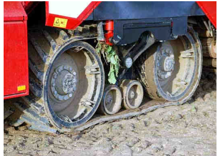
▲ Een rooier op rupsen heeft een lagere bodemdruk dan rooiers op banden.
