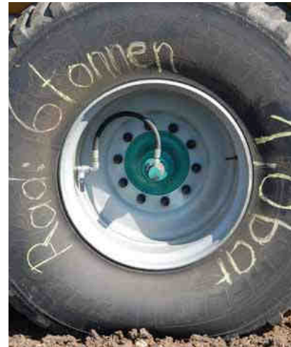
◀ Een snelwerkend drukwisselsysteem is de enige oplossing om met lage bandenspanning op het land te kunnen rijden en met een hoge bandenspanning op de weg. Een snel terugverdiende investering door minder brandstofverbruik én een sterk verminderde bodemverdichting.
