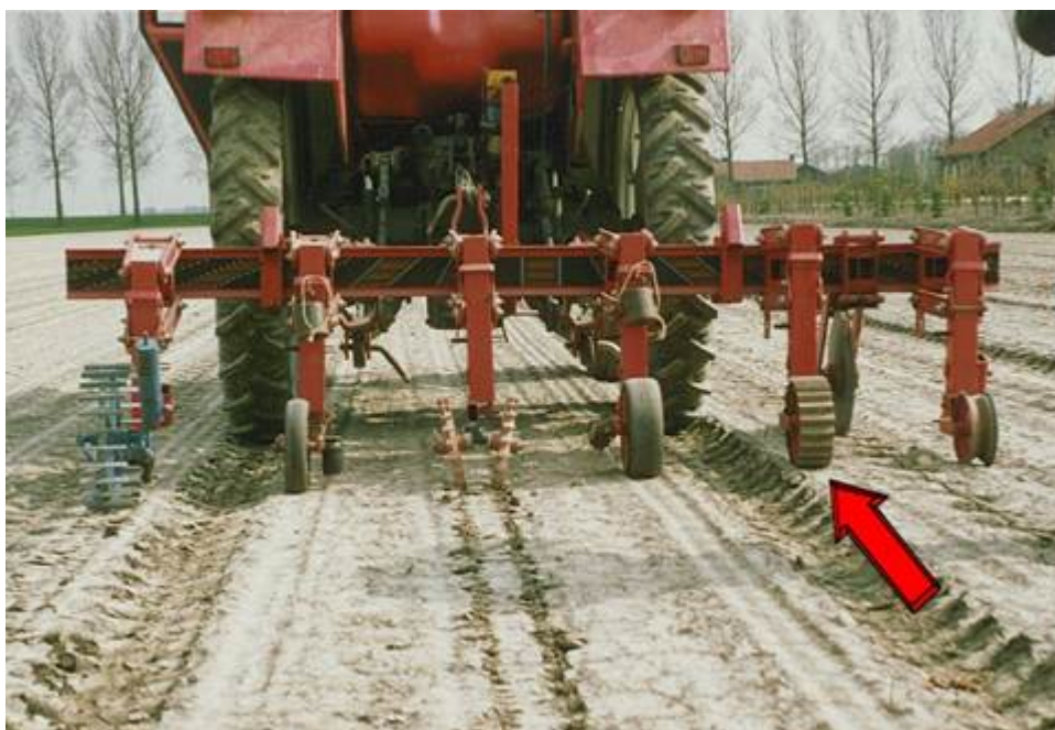
Figuur 3.20 Verschillende uitvoeringen van apparatuur om een korst te breken. Bij een proef in 1992 gaf het aangegeven element de beste resultaten; veel haarscheuren in de korst zonder beschadiging van de kiemplantjes.
