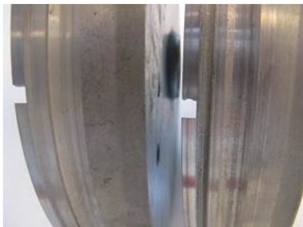
Figuur 3.18 Links een goedgekeurde en rechts een afgekeurde zaaischijf van de Kleine Unicorn.
