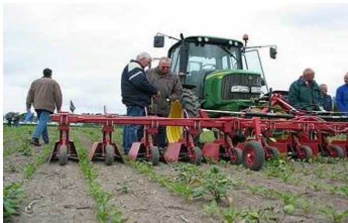
Figuur 6.1.5 Kappenspuit; het monteren van de machine in de frontheef biedt goed zicht op het werk.
