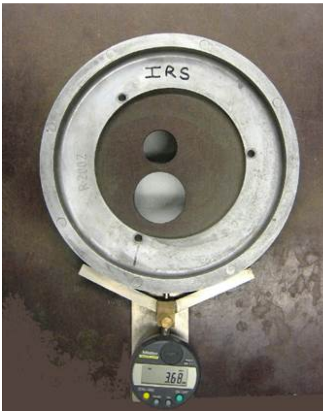
Figuur 3.14 Een micrometer meet de celdiepte van de schijf.
