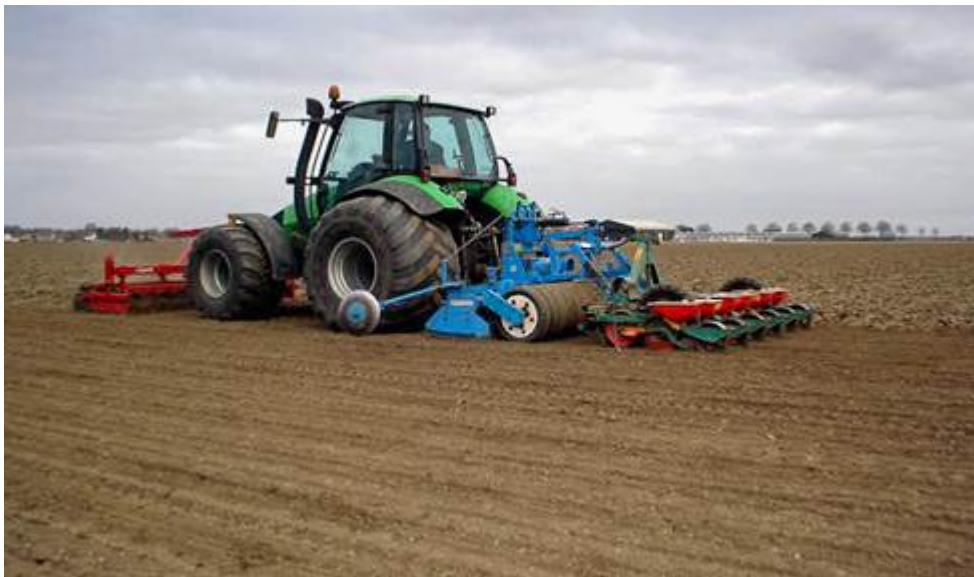
Figuur 2.10 Ideaal: gunstige omstandigheden, zaibed maken en zaaien in één werkgang en rijden met een lage bandspanning.
