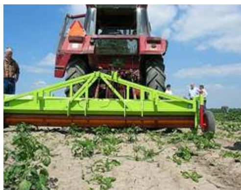
Figuren 6.1.2 en 6.1.3 Bij voldoende hoogteverschil tussen opslag en suikerbiet kan de teler met een onkruidstrijker ook de aardappelplanten in de rij bestrijden.
