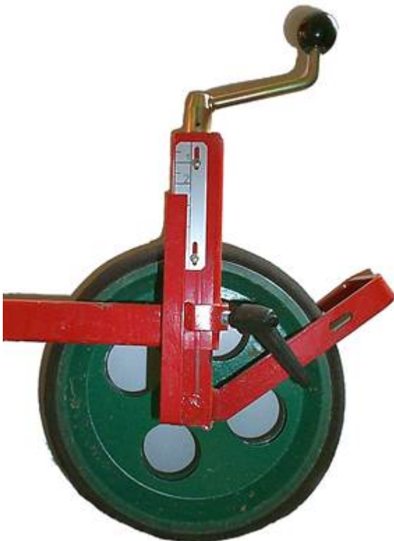
Figuur 3.10 Een verstelbare aanduiding van de zaaidiepte.
