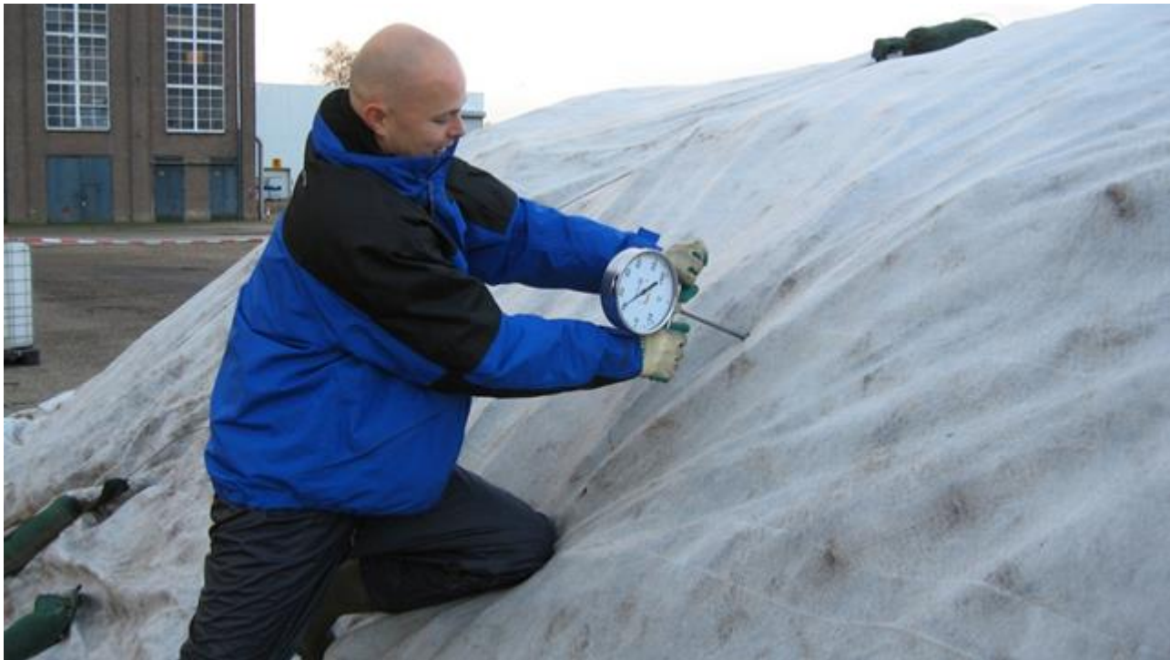
Figuur 8.20 Gebruik van een steekthermometer om de temperatuur in de hoop te controleren.
