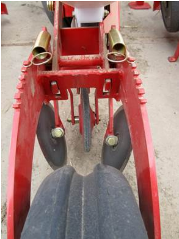
Figuur 3.13 Twee schijfjes die dienen als toestrijker. Op percelen met veel gewasresten aan de oppervlakte voorkomt dit stropen.
