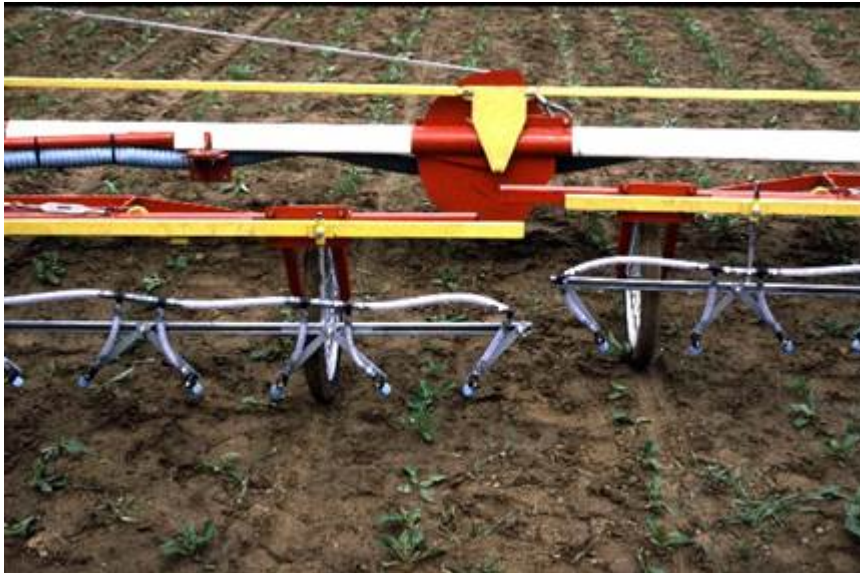
Figuur 6.2.1 Bij een tweedopsrijenspuit staan de spuitdoppen niet recht boven de gewasrij, maar onder een hoek.
