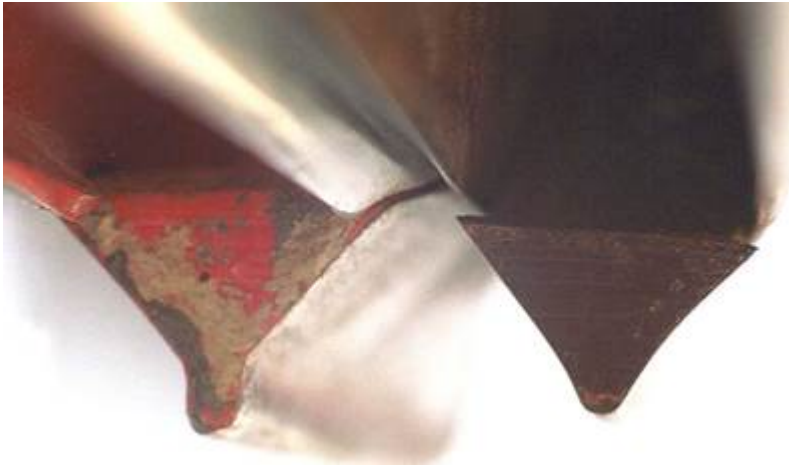
Figuur 3.11 Links een scherp kouter met de juiste druppelvorm, rechts een versleten kouter.
