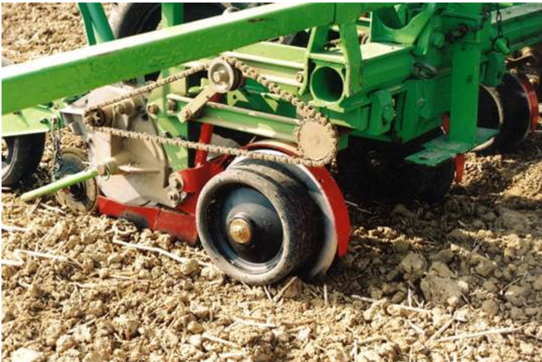
Figuur 3.12 Het monteren van een schijfkouter voorkomt stropen op percelen met veel gewasresten.
