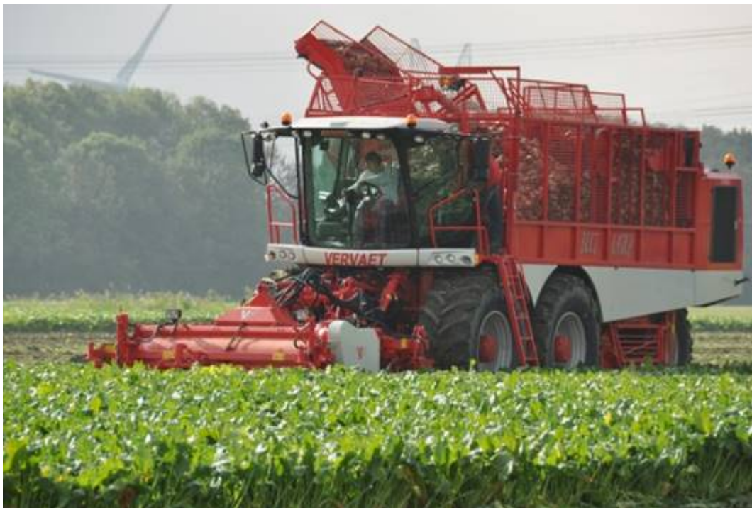
Figuur 8.2.1 Een moderne zesrijige bunkerrooier die in één werkgang de bieten root en verzamelt in een grote bunker van meer dan twintig ton bieten.
