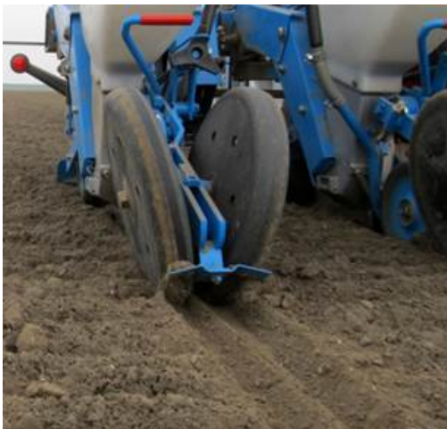
Figuur 3.5 Twee drukrollen in V-vorm.
