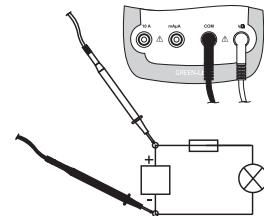
Voor het meten van wisselspanningen “AC” ( $V\text{---}$ ) gaat u als volgt te werk:
