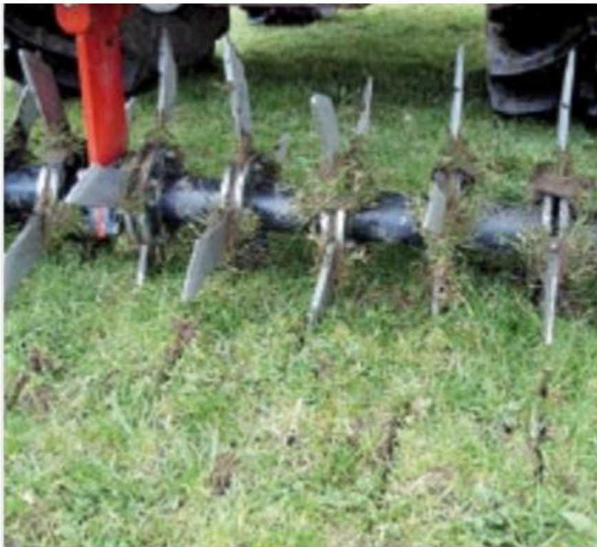
Het effect van een zodebeluchter. Door openingen in de graszode wordt water sneller afgevoerd waardoor minder snel wateroverlast optreedt.
