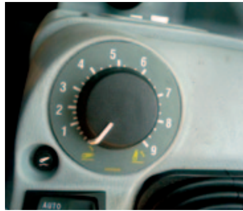
2 Met de draaiknop voor positieregeling kun je de hefinrichting laten stijgen of zakken. Indicatielampjes geven dat aan.
