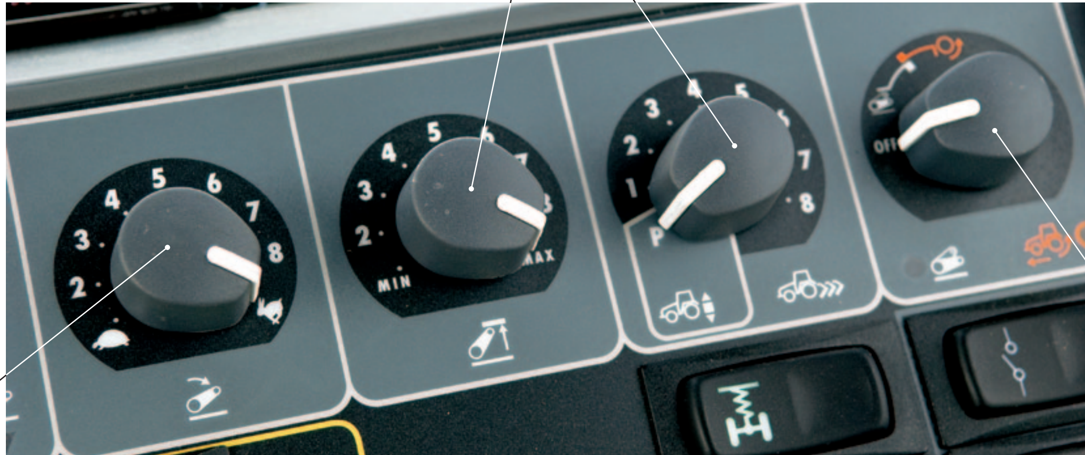
Een nok op de hefarm (die een voeler in de sensor bedient) geeft een spanning door, die overeenkomt met de hoogte van de hefarmen. Met de draaiknop voor de positieregeling kun je de hoogte van de hefarmen instellen. Met knop 3 begrenst je de maximale hefhoogte.
