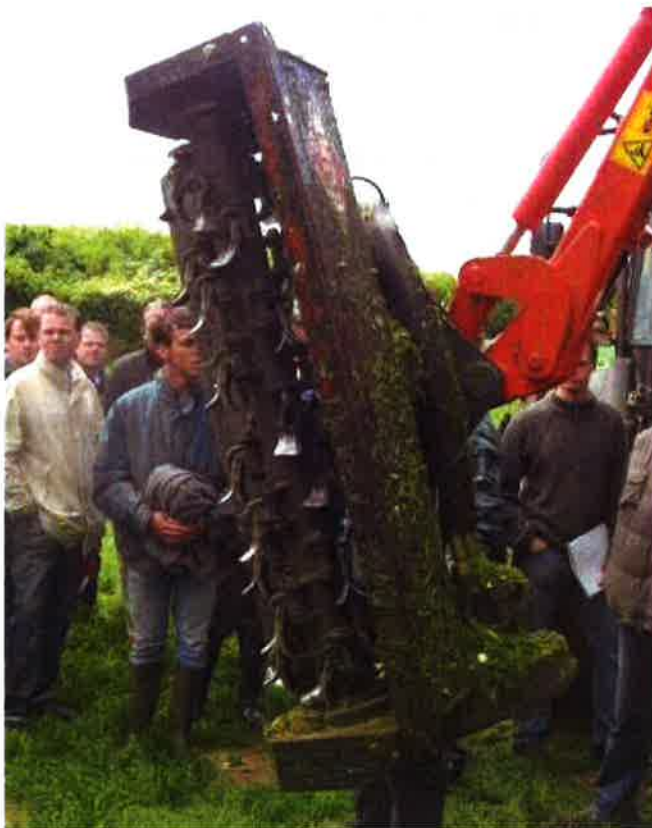
Figuur 3 – Robuuste klepelmaaier of klepelrotor die kan ingezet worden bij het beheer van hagen en heggen.
