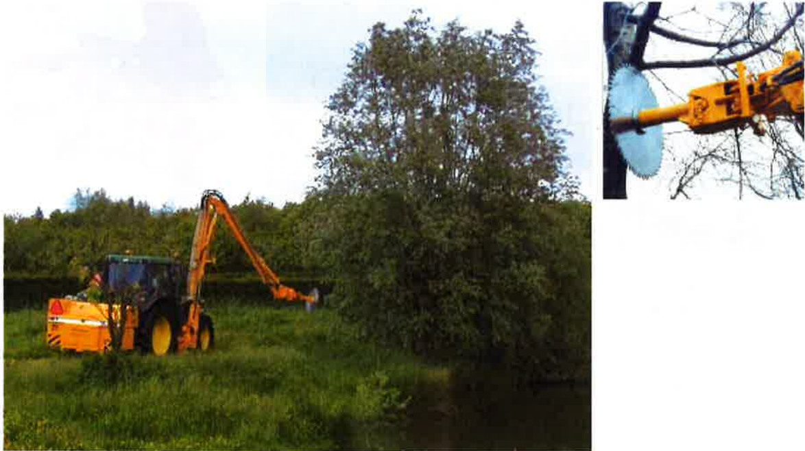
Figuur 9 – De eenvoudige cirkelzaag kan ingezet worden bij het knotten van bomen
