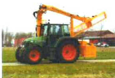
Dit aan de werkversie te voldoen met een lange arm, transporthoogte onder 1,0 meter, heeft Bos een nieuwe arm gemaakt. De tweedelige giek heeft een extra klink zodat de arm laag over de ebanne kan kriskken. Het werktuig hangt achter de trekker zodat er minder wind op de trekker valt.
