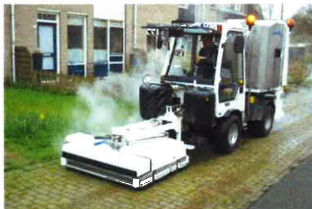
Figuur 44 – Deze heetwatertoepassing met hydraulische arm (WAVE) zorgt voor een grotere productiviteit dan de toepassing met een spuitlans.
