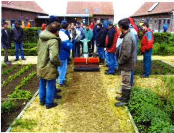
Figuur 41 – Met de rotorkoep kunnen verkreide losse verhardingen opgefrist worden. De tanden werken door een roterende beweging de onkruiden los; de verkreimelrol egaliseert de bodem.
