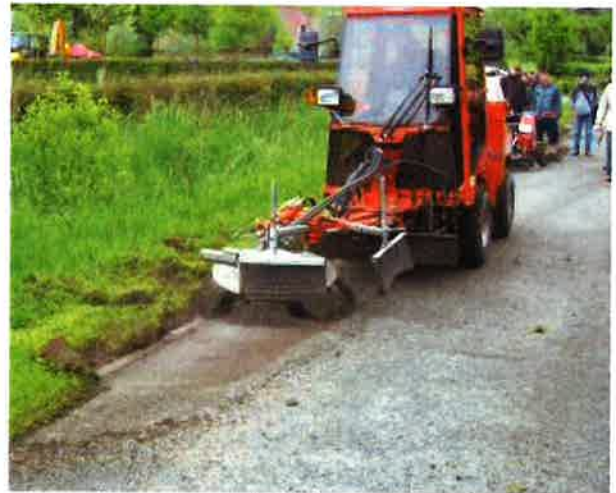
Figuur 40 – Bij horizontale borstels is er vaak nog extra werkgang nog om het afgeborstelde materiaal te verwijderen. Hier is de borstel gemonteerd op een vierwielige werktuigdrager die een hoge wendbaarheid verzekert.
