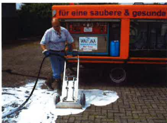
Figuur 43 – Waipuna-systemen werken met heetwater veelal met biologisch afbreekbaar schuim om het onkruid thermisch te bestrijden. Via spuitlansen wordt het water aangebracht. De lansen zijn handig bij het beheer van moeilijk bereikbare plaatsen.
