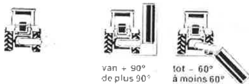
Figuur 22 – Verschillende mogelijkheden om het maai-element te verplaatsen tegenover de trekker.
