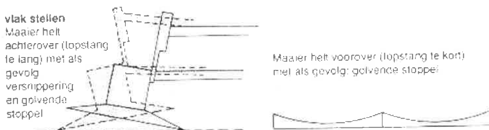
Figuur 15 – Onjuiste vlakstelling van de maaibalk (illustratie: trommelmaaier)
