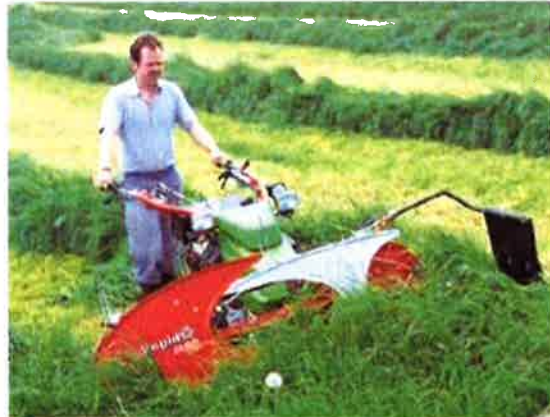
Figuur 30 – Bij dit aanbouwtuustel voor een eenasser zijn een maaibalk en een bandhooier geïntegreerd. Zo wordt de vegetatie in een werkgang afgesneden en op een zwad gelegd voor de inzameling.
