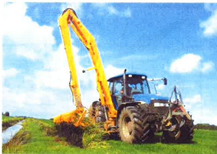
Vertrouwd beeld in ons waterrijk land: slootreinigen met een trekker met een lange, hydraulische zijarm met maaiarm. Deze lange arm kan multifunctioneel worden ingezet, zoals met een klepelbal, takkenschaar en afzetting.
