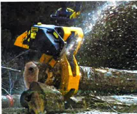
Figuur 8 – Met de hydraulische tang met kettingzaag kunnen ook bomen geknot worden. Het werktuig bestaat uit een grijptang met onderaan een kettingzaagblad.
