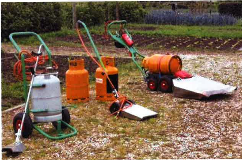
Figuur 42 – Diverse handmachines voor het branden van ongewenste kruidgroei. Hier worden zij bijvoorbeeld ingezet op een dolomietpad.
