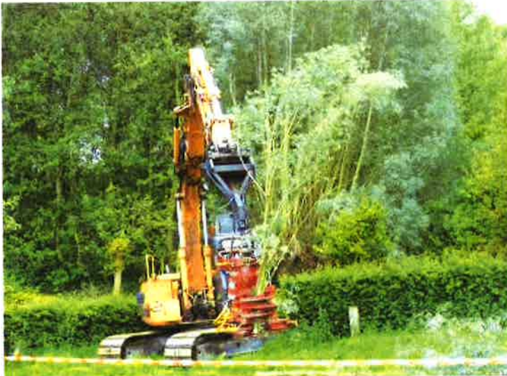
Figuur 7 – Met de hydraulische knipschaar kunnen bomen geknot worden (1). De knipschaar bestaat uit een grijptang (r, boven rood), met daaronder het eigenlijke snijsysteem met gripper (r, onder zwart). Eventueel kan de grijptang afwezig zijn.
