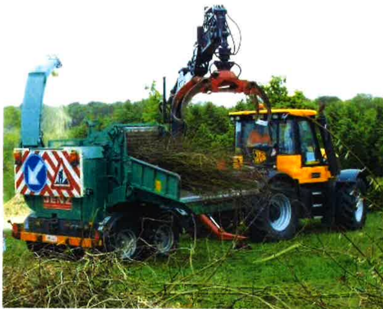
Figuur 11 – Bij houtversnipperaars met een grote capaciteit hoort vaak een kraaninvoer.
