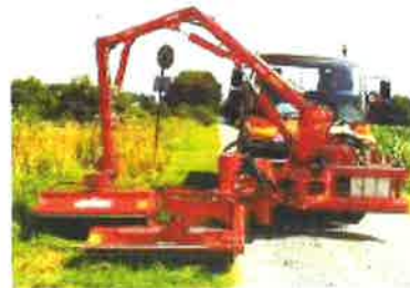
Nieuw van Duro is de DVA hydraulische frontarm met een sideshift. De arm is draaibaar zodat links en rechts gewerkt kan worden. Mogelijkheid is een tweede maaihoof. In Duitsland draait inmiddels de eerste arm een Lanning. In ons land is het de eerste verkocht aan een trekker.
