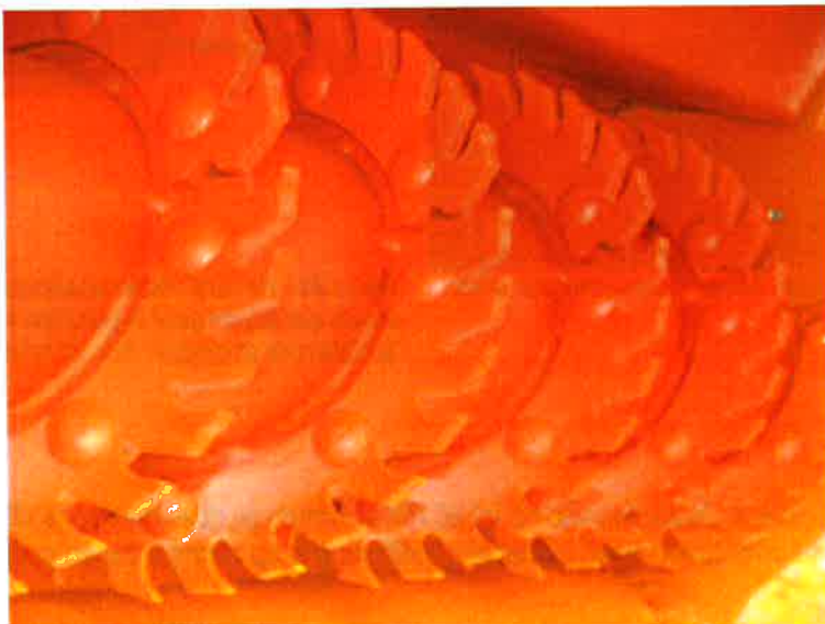
Figuur 25 – De centrale as met spiraalsgewijze montage van de de tanden
