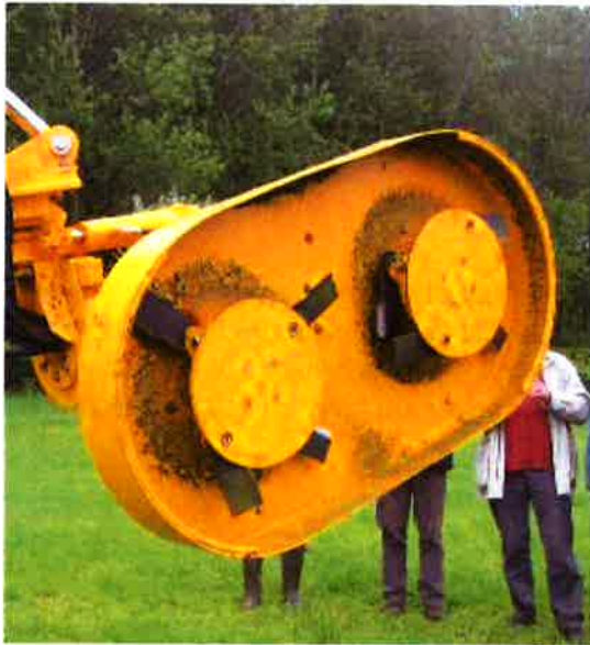
Figuur 5 – Met deze slagmaaier met tweemaal vier losse messen worden de twijgen gesnoeid en meteen versnipperd.
