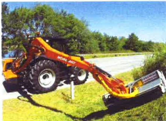
Ook Votex heeft sinds kort lange armen voor in de driepunt. Dit zijn de Franse Noremat armen die onder Votex naam verkocht worden. De grootste is de Magistra 83T van 8,3 meter. De Noremat armen hebben een klink in de giek zodat de manier meer naast de trekker komt.
