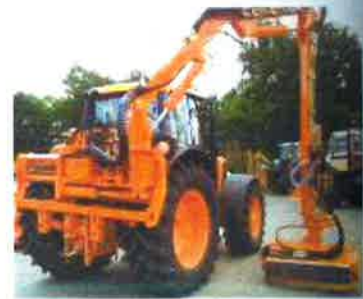
Net uit de fabriek komt de Gólde GHA 700 SM. Deze lange arm van bijna 8 meter zit op een soort rail in de driepunt. Hij kan draaien tot naast de trekker en ook tussen de voors en achterwiel onder de trekker komen.
