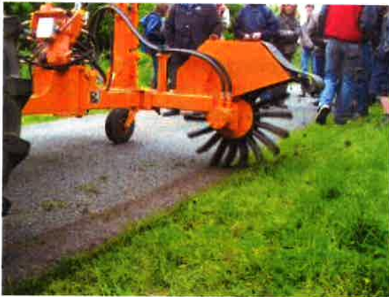
Figuur 39 – Bij verticale borstels – hier gemonteerd op een landbouwtrekker – wordt het verwijderde materiaal in de aangrenzende berm geworpen.
