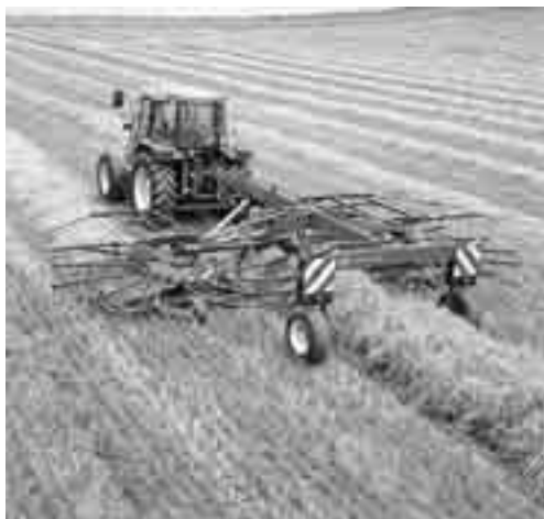
Fig. 9.1 Getrokken cirkelhark met twee harkelementen en middenafleg
