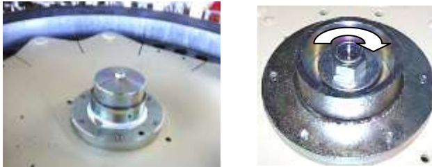
Figuur 6-1 Instellen van de druk op de messen.
