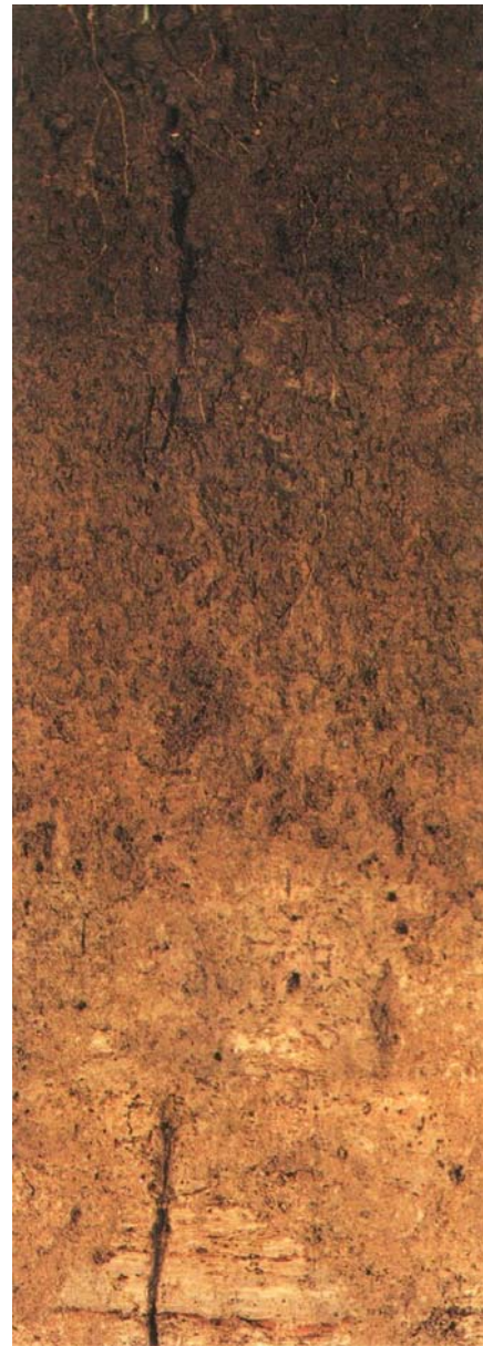
Figuur 2-5: Profiel van een rivierkleiggrond
