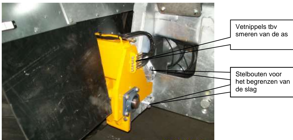
Figuur 6-1 slagbegrenzing pendelsysteem
