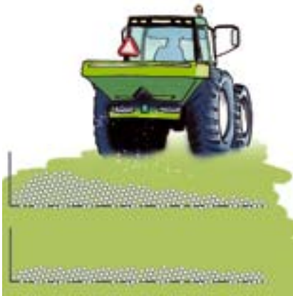
◀ Een goed afgestelde kunstmeststrooier is een eerste vereiste voor een goede verdeling van kunstmest. Nauwkeurig kunstmest strooien op grasland blijkt lastig. Moderne hulpmiddelen op basis van GPS-techniek kunnen flink helpen om de verdeling van (kunst)mest op grasland te verbeteren. Een goed afgestelde kunstmeststrooier is een eerste vereiste voor een goede verdeling van kunstmest.
