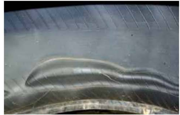
Sjef Houtenbos' Trelleborgs (710/70 R42) waren na een jaar en 1.500 draaiuren voor driekwart versleten. De binnenkant zat vol luchtballen (zie kader links).
