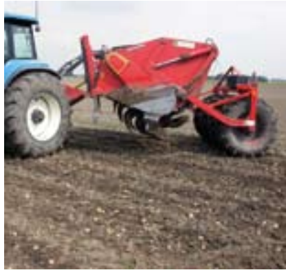
Diepspitten met roterende machine tot één meter diep. Het mengen van storende lagen met andere lagen kan het profiel verbeteren.
