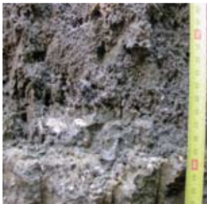
▲ Opheffen van een storende laag waarop water blijft staan, is nodig om de drainage te verbeteren.
