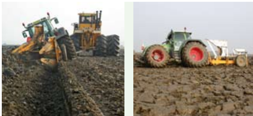
Diepploegen met twee risters tot twee meter diep. Bij dieper ploegen dan een meter wordt in twee fasen geploegd: een ploegschaar ploegt de bovengrond naar beneden en de andere ploegschaar ploegt de ondergrond naar boven.
