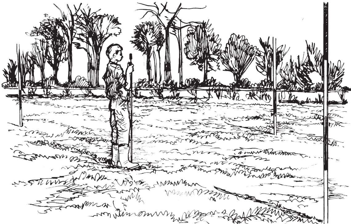
Figuur 2.10 Zo gebruik je de dubbelpentagoonprisma in het veld.
