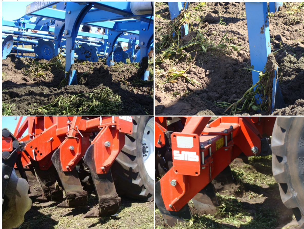
Figuur 22. Enkele voorbeelden van werktuigen voor niet-kerende grondbewerking. Boven: tandcultivator met smalle beitels, en achteraan twee rijen gekartelde schijven. Onder: woelbalk met gebogen woelpoten (type decompactor), gevolgd door twee rijen gekartelde schijven.
