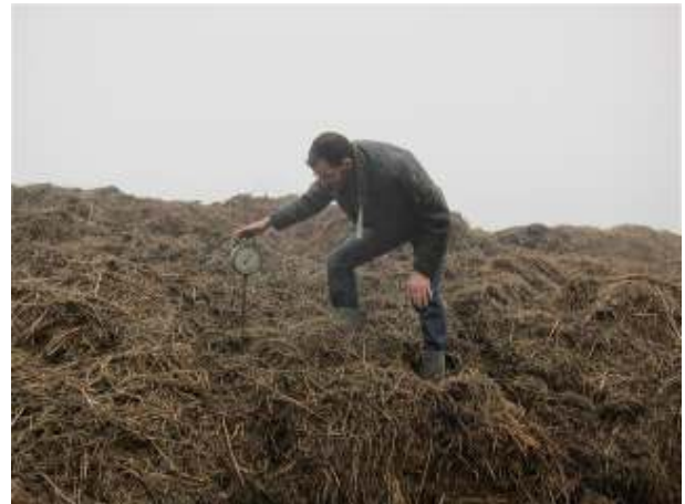
Volgen van de temperatuur tijdens het composteren van maaisel.
