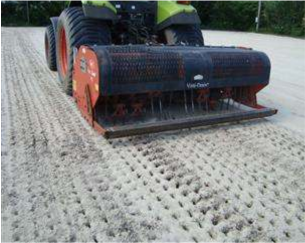
11. De vertidrainmachine maakt gaten waar het zand ingespoeld kan worden
