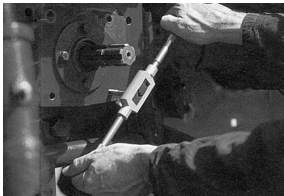
figuur 3.47 Tappen van nieuw schroefdraad
