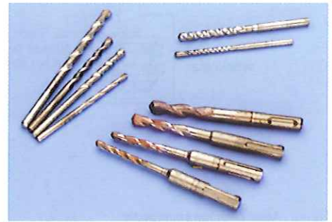
Fig. 22 Steenboren en betonboren
