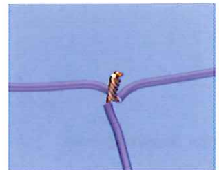
verbinding van geleiders of aftakking
