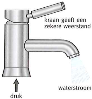
Fig.1 Waterstroom uit een kraan
