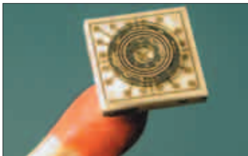
Micromotor gemaakt van nikkel en plexiglas met behulp van een speciale lithografiertechniek om driedimensionale microstructuren te realiseren. Hierbij wordt gebruik gemaakt van synchrotronstraling.
