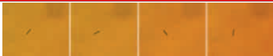
Nanomotoren kunnen op macroscopisch niveau arbeid leveren: aangedreven door moleculaire rotoren draait een klein glasstaafje rond binnen een matrixpatroon. De afmeting van dit staafje bedraagt 5 bij 28 micrometer. Vanuit menselijk perspectief gezien is dat klein, maar vergeleken met het formaat van een motormolecuul heeft dit staafje reusachtige dimensies.
