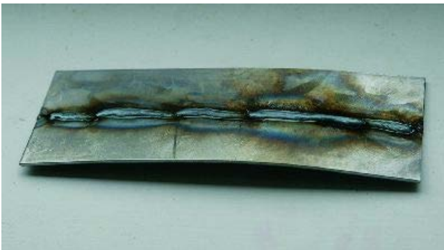
Figuur 3-25: Door lengtekrimp kunnen dunne platen bij de lasnaad gaan rimpelen.
