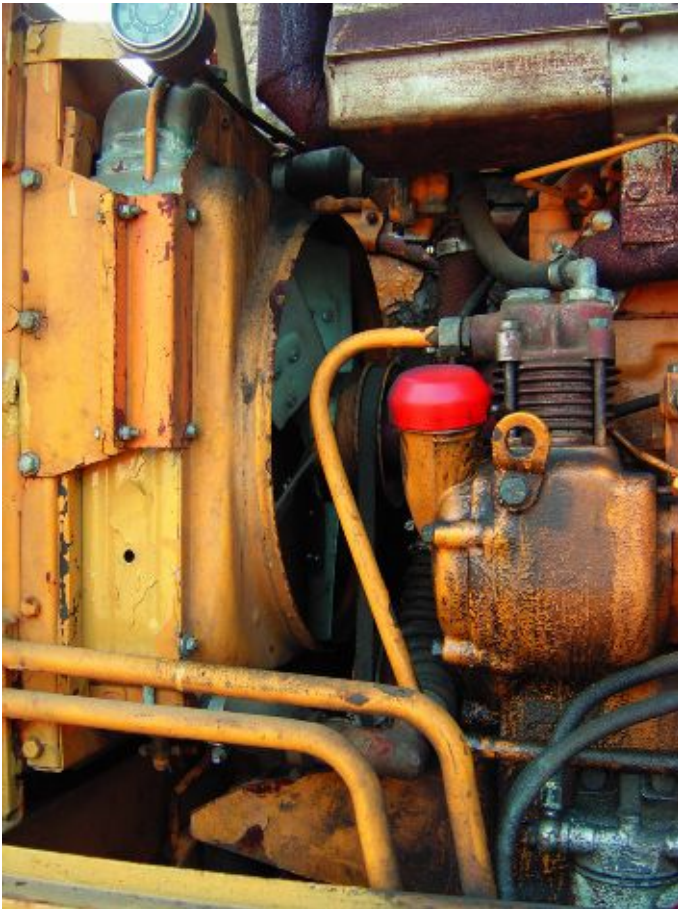
Figuur 5-32: Bij geforceerde vloeistofkoeling wordt vloeistof rondgepompt.
