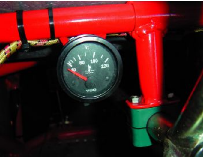
Figuur 5-34: Een meter geeft de motortemperatuur aan.
