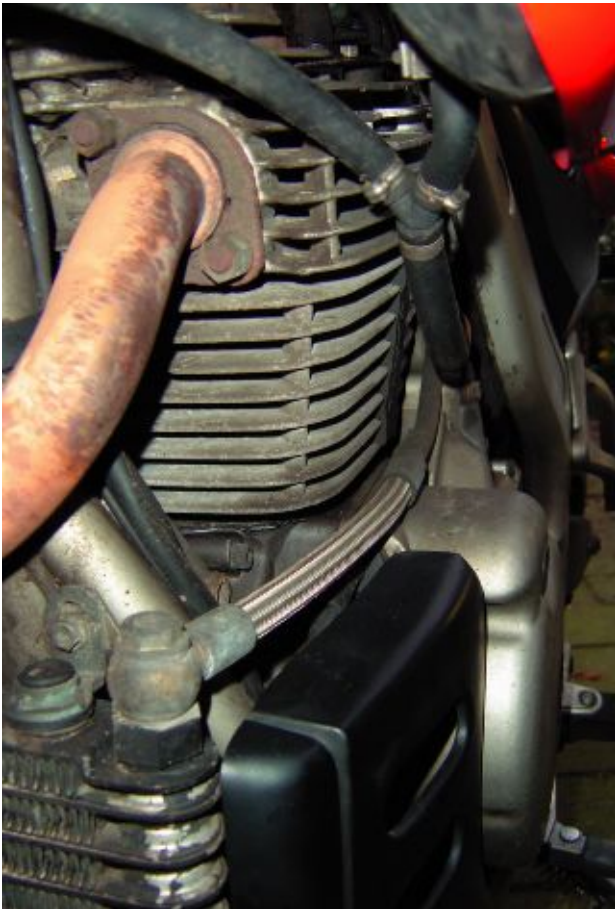
Figuur 5-30: Bij rijwindkoeling is de cilinder omgeven door koelribben.
