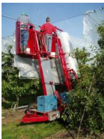
Foto 31: de machine (Mollema) waarmee de folie wordt opgehangen wordt door een trekker (niet zichtbaar op de foto) naar rechts getrokken. Persoon 2 (rechter persoon op foto) geleidt de folie over de draad en zet hem voorlopig vast, persoon 3 (linker persoon op foto) bevestigt de overige clips en borgt ze met een tweede clip, die over de eerste wordt geschoven (foto 32).
