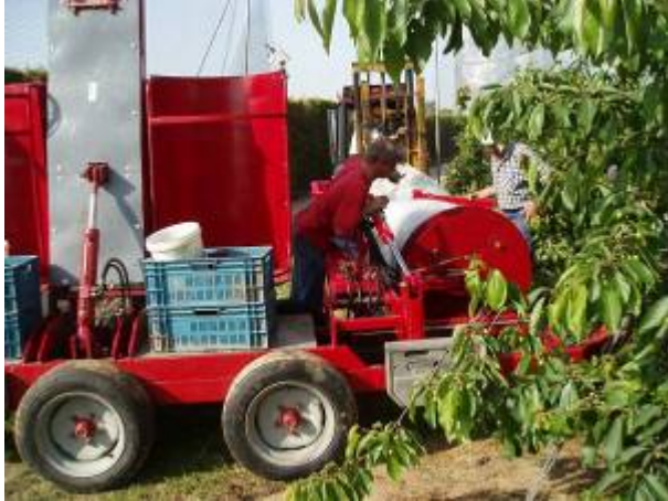
Foto 34: Aanbrengen van een nieuwe rol folie op de machine
