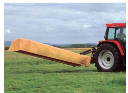
Hydraulisch kan de maaier geheven worden zonder dat de hefinrichting wordt gebruikt.
