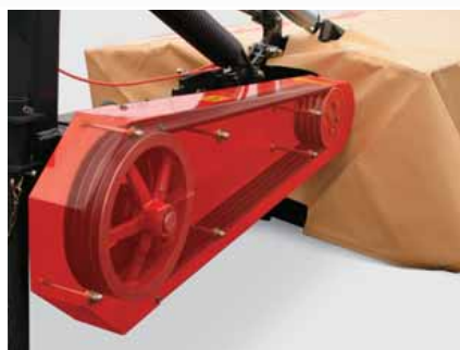
Een V-snaar aandrijving beschermt de maaier tegen overbelasting als er obstakels zijn.
