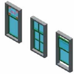
Oorspronkelijke kozijnen uit de bouwperiode van voor 1900
