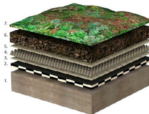
Figuur 9: Basisopbouw daktuin met wortelwerende dakbedekking.
