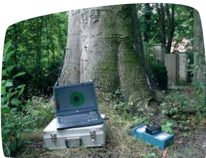
De geluidstomograaf gebruikt geluidsgolven om een tweedimensionaal beeld van de binnenkant van de boom te geven. (Foto Peter Van Herp)
