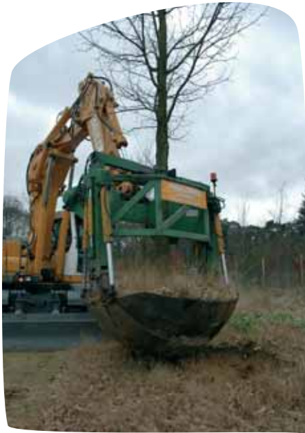
Het verplanten van grote bomen kan gebeuren met verplantmachines.
