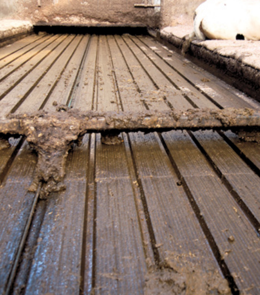
De combischuif klappt omhoog wanneer hij teruggaat naar zijn startpunt. Hierdoor schuift de mest naar één zijde van de stal.
