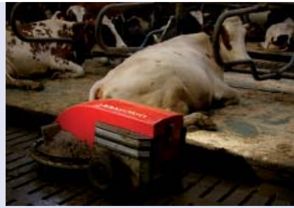
Zoals voorgeschreven in de handleiding passeert de Lely Discovery met de gesloten rechterkant de boxen. De koeien storen zich niet aan de robot noch aan de plepton.
