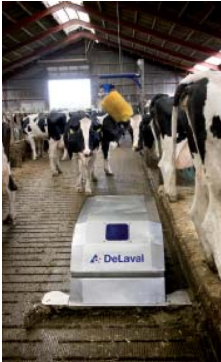
De Delaval mestrobot RS 250 is identiek aan de Joz-tech.
