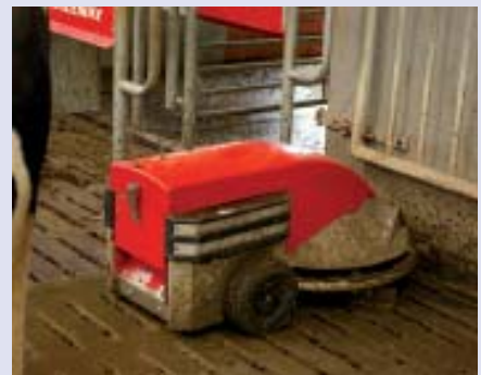
De Lely Discovery oogt elegant. Onder de rode kunststofkap zitten twee rijmotoren, de accu en een printplaat. Extra gewichten in de bak zorgen voor voldoende grip op de ondergrond.
